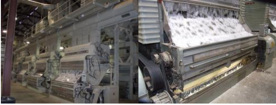
Şekil 1: Sawgin tipi çırçır makinası
